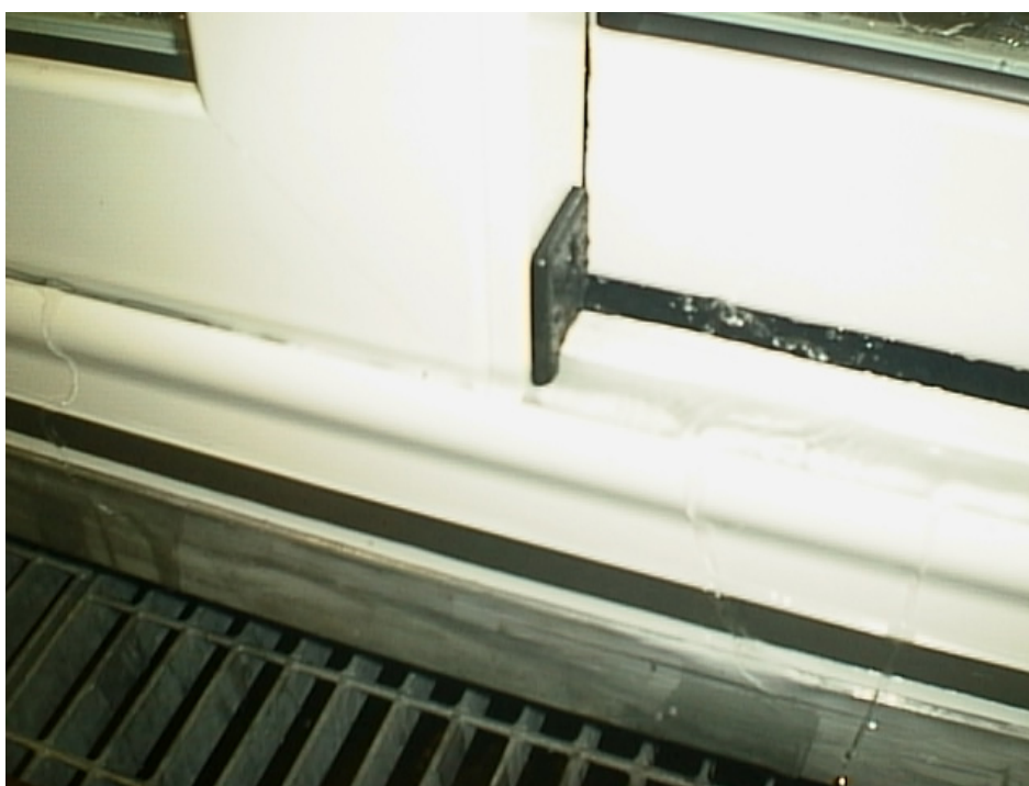
Foto 3: Perdite del campione durante la prova di tenuta all'acqua
