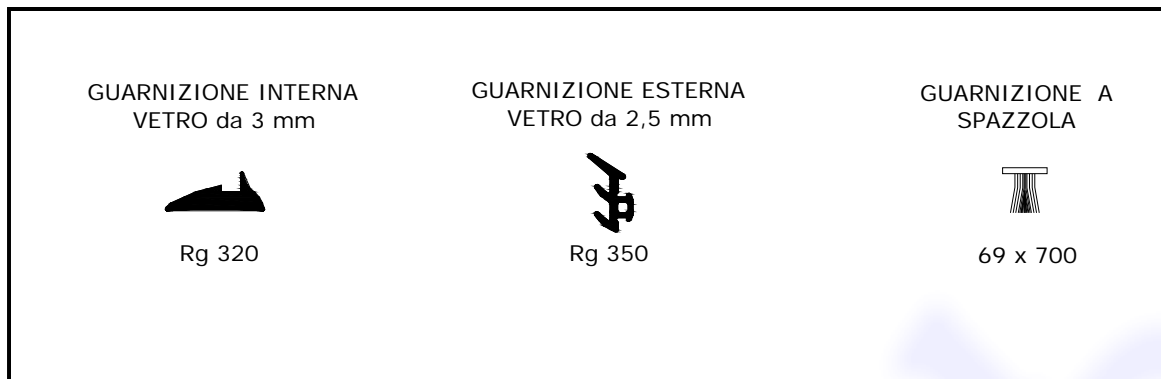
Fig. 4a: Dettagli del sistema di tenuta del campione pervenuto e sottoposto a prova (dimensioni nominali dichiarate, espresse in mm)
