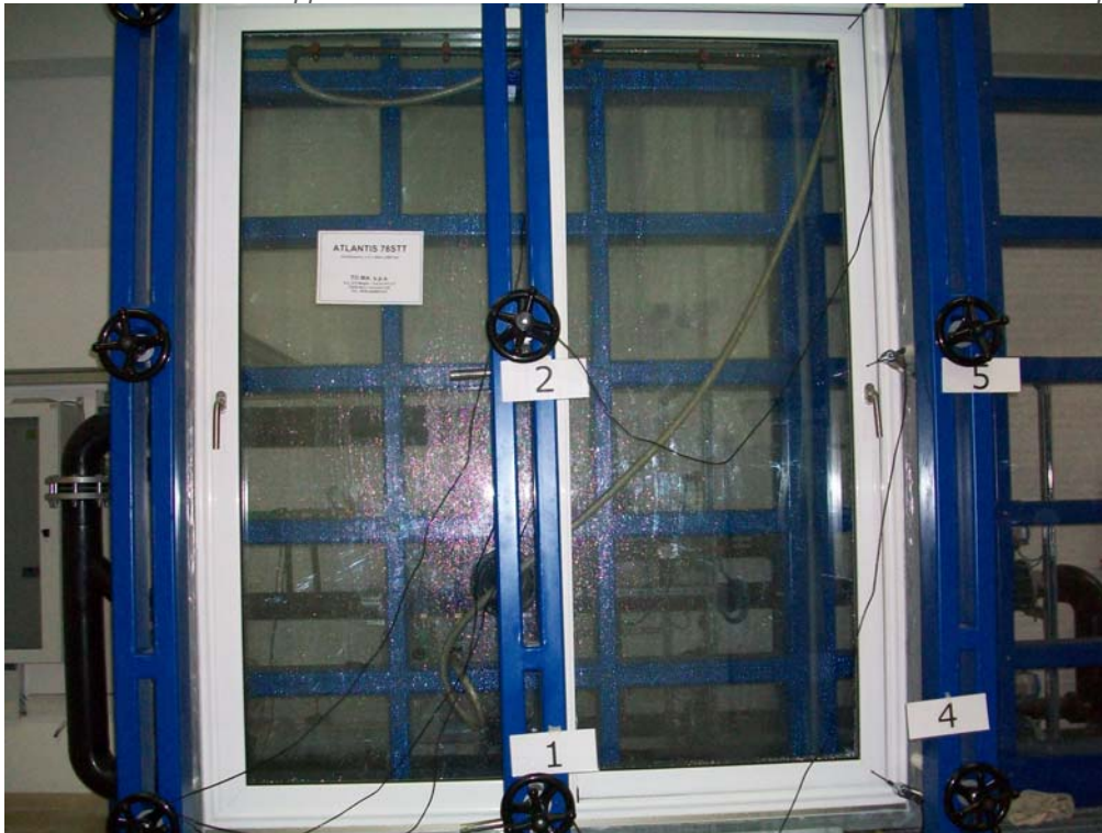
Foto 4: Campione durante la prova di resistenza al carico del vento (prova di deformazione)
