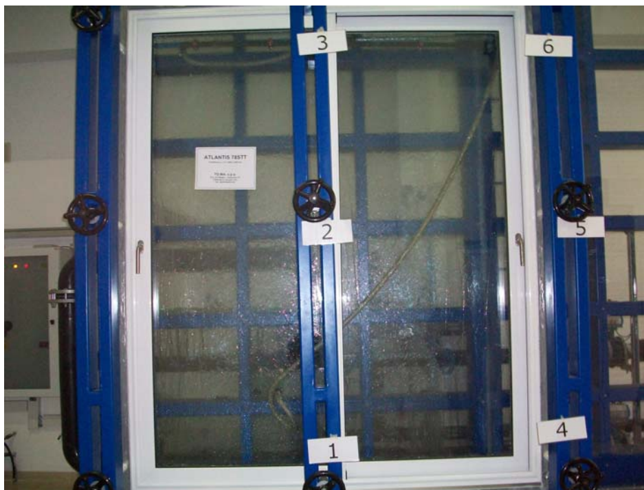
Foto 2: Campione durante la prova di tenuta all'acqua
